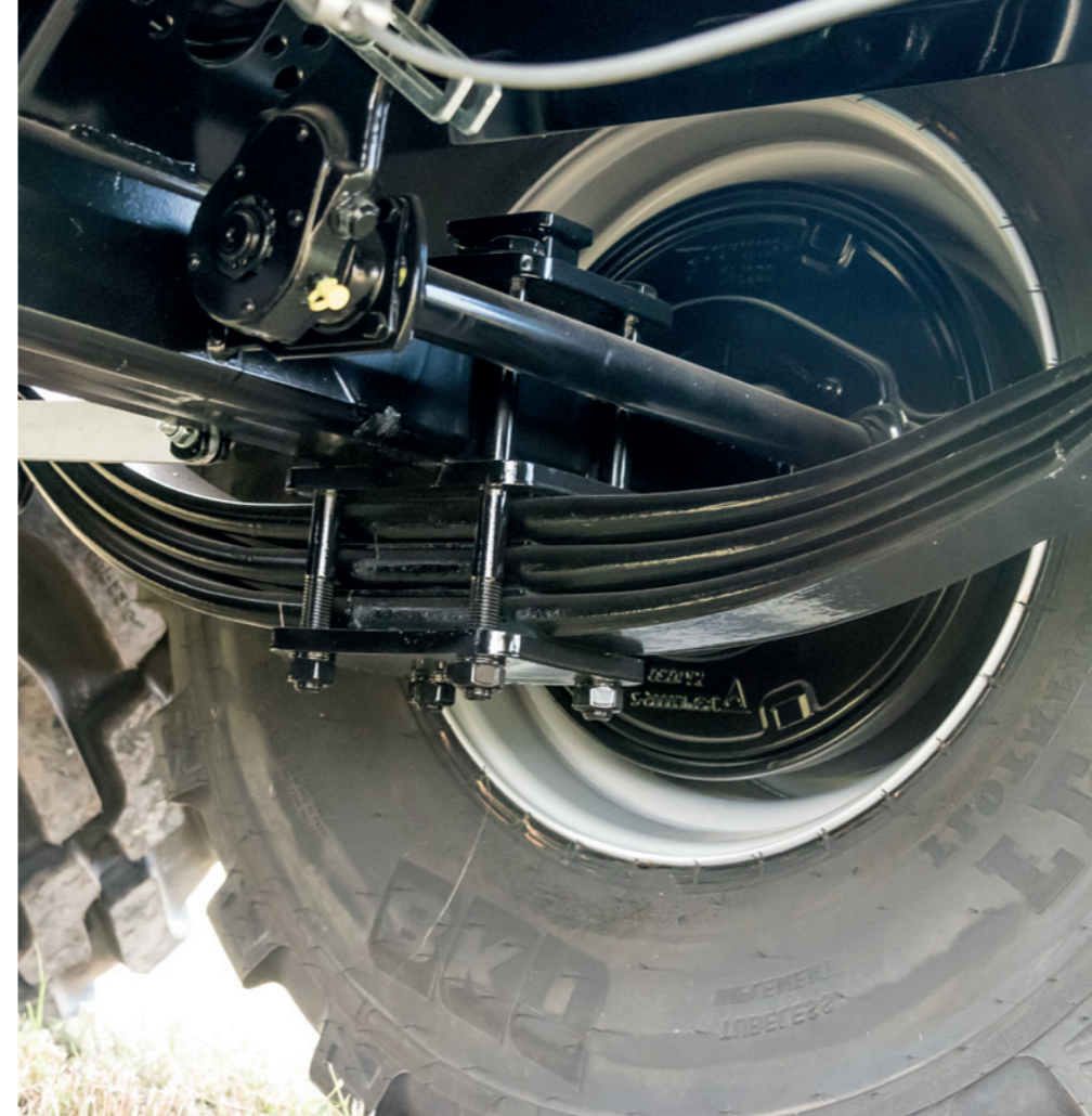
32t układ resorujący z wzmocnionym układem wahadłowym
