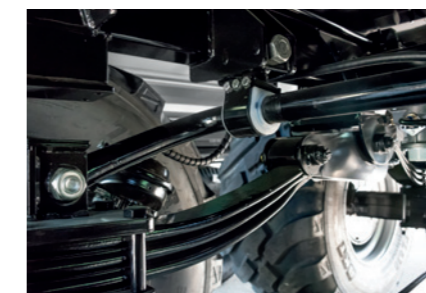
32t układ resorujący z wzmocnionym układem wahadłowym
