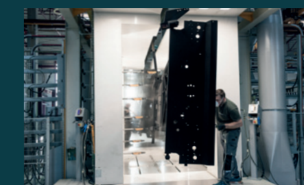
Automatyczne malowanie proszkowe
