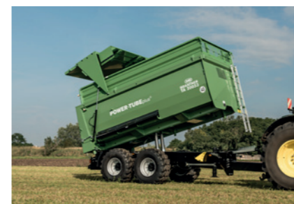
TA 20053/2 PT z korytem stożkowym, wykonany w całości z blachy stalowej o grubości 4 mm
