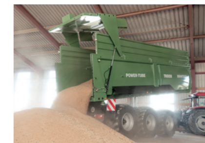
TR 34080/2 PT+ 34t masy całkowitej, na życzenie z hydrauliczno-mechanicznym lub elektrycznym wymuszonym kierowaniem
