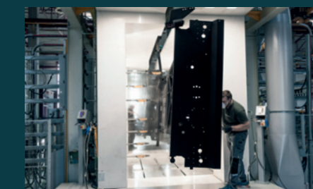
Automatyczne malowanie proszkowe
