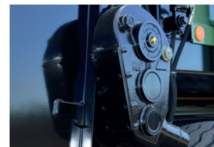
Bezstopniowy napęd podłogi przesuwnej solidna przekładnia zamontowana w kąpielii olejowej
