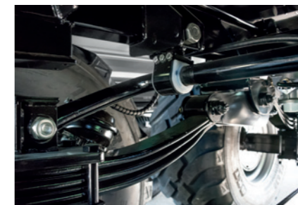
Stabilizator resorów wysoce zalecany do osi skrętnych (możliwy tylko z zawieszeniem parabolicznym)
