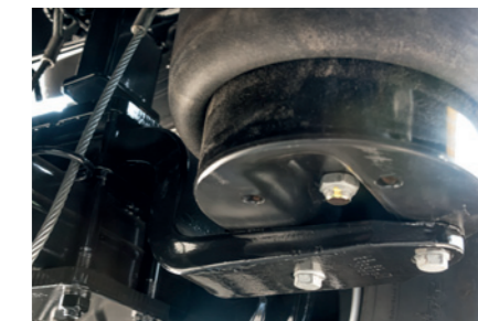
Zawieszenie pneumatyczne z dwupiętrowym wahaczem dla optymalnej stabilności i mobilności w terenie
