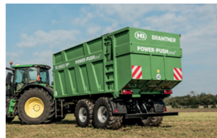
TA 20055 PP+ ze ścianami bocznymi 2000 mm w standardzie
