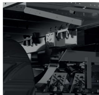
Rama nośna skręcana śrubami
