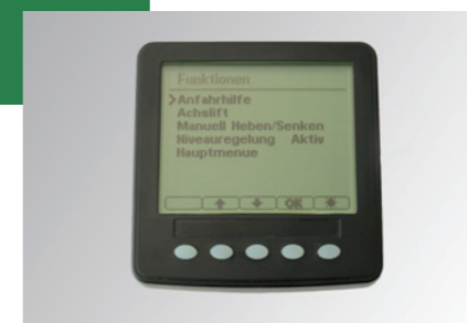
Sterowanie HP Premium osią podnoszoną, wspomaganie traktacji itp.
