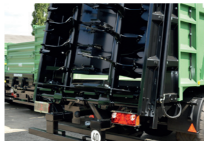
Rozrzutnik z dwoma pionowymi wysokowydajnymi wałkami rozrzucającymi, przykręcane wzmocnione zęby frezujące ze stali Hardox/Quard
