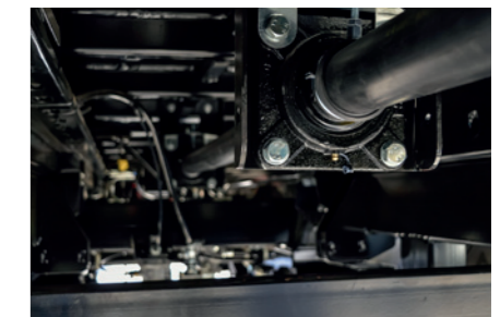
Wał napędowy dla adapteru rozrzutnika lub przenośnika ślimakowego
