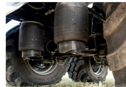
Zawieszenie możliwe różne układy zawieszenia, np. zawieszenie pneumatyczne lub zawieszenie hydrauliczne
