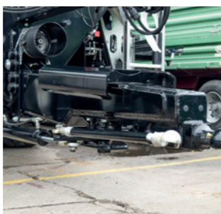
Hydrauliczno-mechaniczny wymuszony układ kierowniczy
