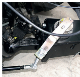
Elektryczny wymuszony układ kierowniczy
