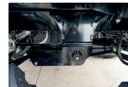
Przesunięte zawieszenie tandemowe dostosowane do osi skrętnych, lepsza stabilność i ograniczenie tendencji do kołysania się
