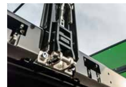
Słupek środkowy, który można zdjąć bez użycia narzędzi, może być pomocny podczas ładowania skrzyń lub palet
