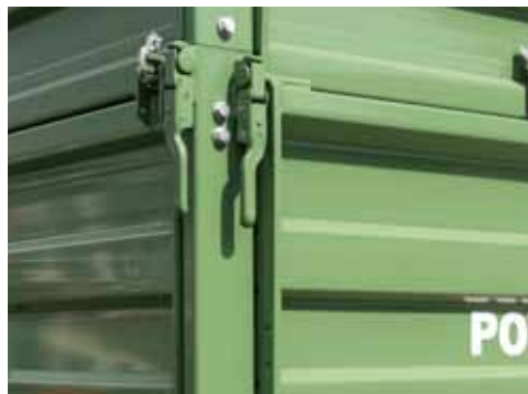
Zamki Hestal, bez wzmocnienia ściany bocznej
