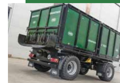
Rynna do optymalnego rozładunku wrażliwych produktów luzem (np. ziemniaków)
