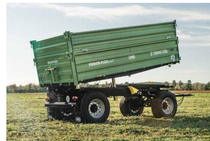
Z 15045 XXL AKTION Opcjonalnie: pakiet PROFI z 2 siłownikami wywrotu, wzmocnieniem ściany bocznej, sprężynami do podnoszenia ściany bocznej i podłogą z blachy stalowej 5 mm
