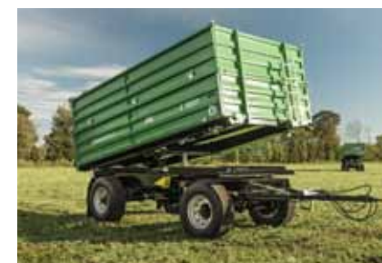
Z 18051 AKTION model podstawowy w sprawdzonej jakości Brantner ze standardową ramą z profili prasowanych typu podwójnego C
