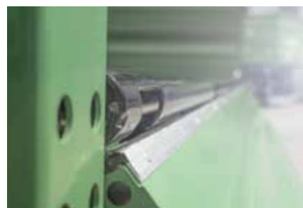
Samoczyszcząca krawędź mostka szlifowana ze wszystkich czterech stron
