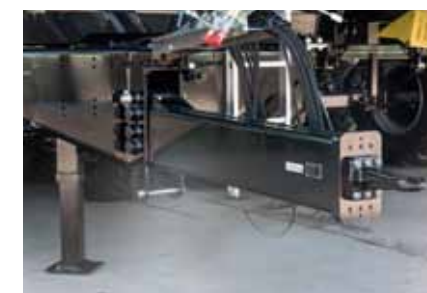
Dyszel zaczepu o regulowanej wysokości wykonany z podwójnego tłoczonego profilu C, jako mocowanie górne i dolne
