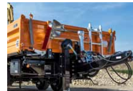
Przyczepa niskopodwoziowa TA 13045 z dyszlem o regulowanej wysokości w standardzie, opcjonalnie dostępne uchwyty na łopaty i miotły
