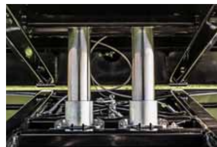
Chromowany na twardo cylinder wyrotu z przegubem jeden- lub dwa w zależności od wersji
