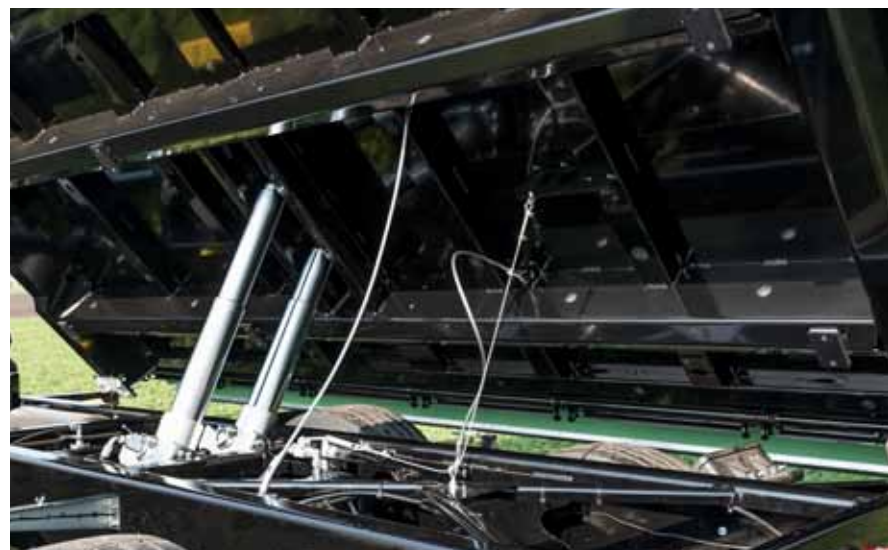
Trapezowa rama wychylna zgodna z projektem samochodów ciężarowych wraz ze wzmocnieniami usztywniającymi
