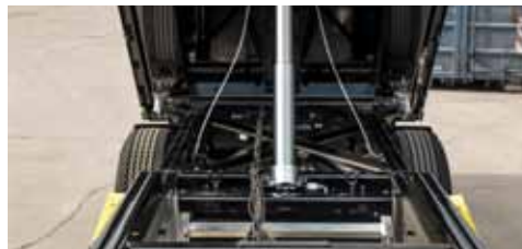
Wersja z jednym siłownikiem wywrotu
