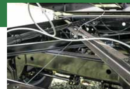
Wzmocnienie krzyżowe - zwiększona sztywność skrętna
