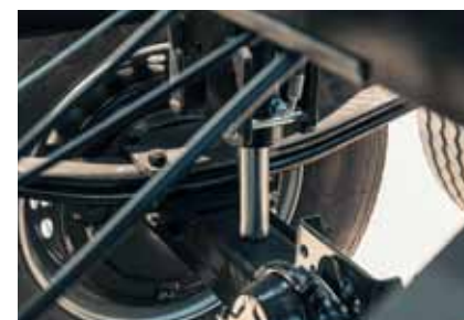
Hydrauliczne podparcie tylnej osi w standardzie dla optymalnego komfortu zawieszenia
