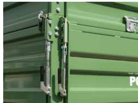
HB - zamki do samochodów ciężarowych, ze wzmocnieniem ściany bocznej
