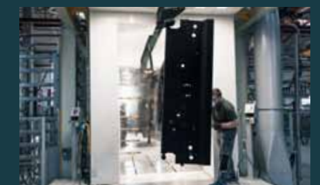
Automatyczne malowanie proszkowe
