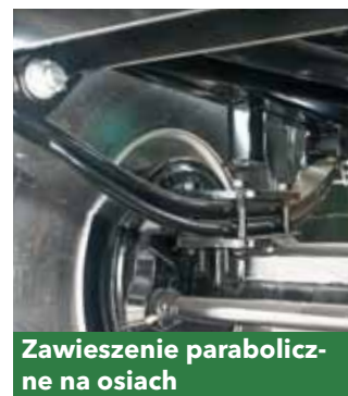
Zawieszenie paraboliczne pod osiami
