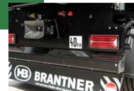
Oświetlenie w standardzie z tylnym światłem Agriled full LED z kierunkowskazami
