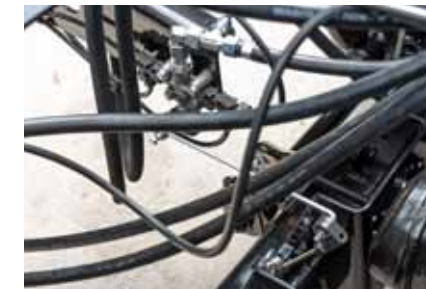
Pneumatyczny system ALB zapewni odpowiednią regulację siły hamowania
