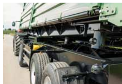
Trapezoidalna rama wywrotu typu ciężarowego z łożami wywrotu umieszczonymi daleko na zewnątrz
