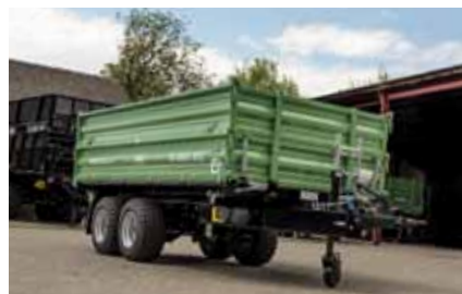
TA 8045 XXL z hamulcem najazdowym i nadstawkami 500 mm
