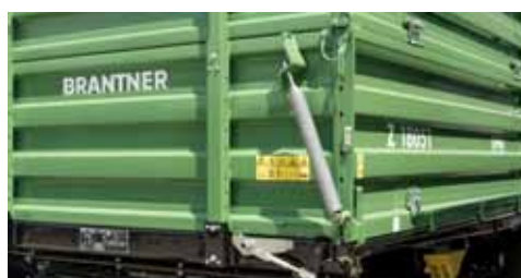
Prosta sprężyna do podnoszenia burty bocznej
