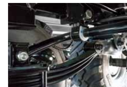
Stabilizator resorów dostępny jako opcja, zalecane do osi skrętnych
