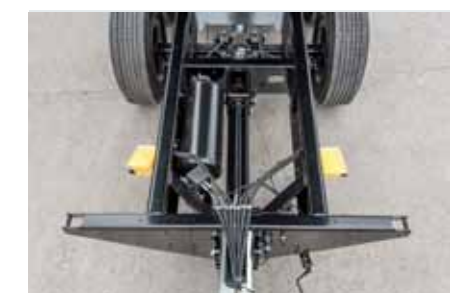
Rama prostokątna z profili tłoczonych G lub podwójnie C
