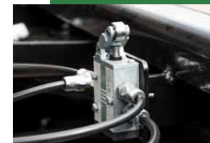
Automatyczne opuszczanie podczas wywrotu
