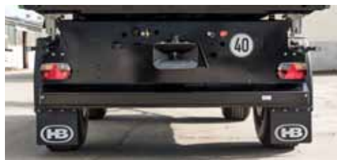
Oświetlenie wielopunktowe Multi-Point z chłapaczami na błotnikach
