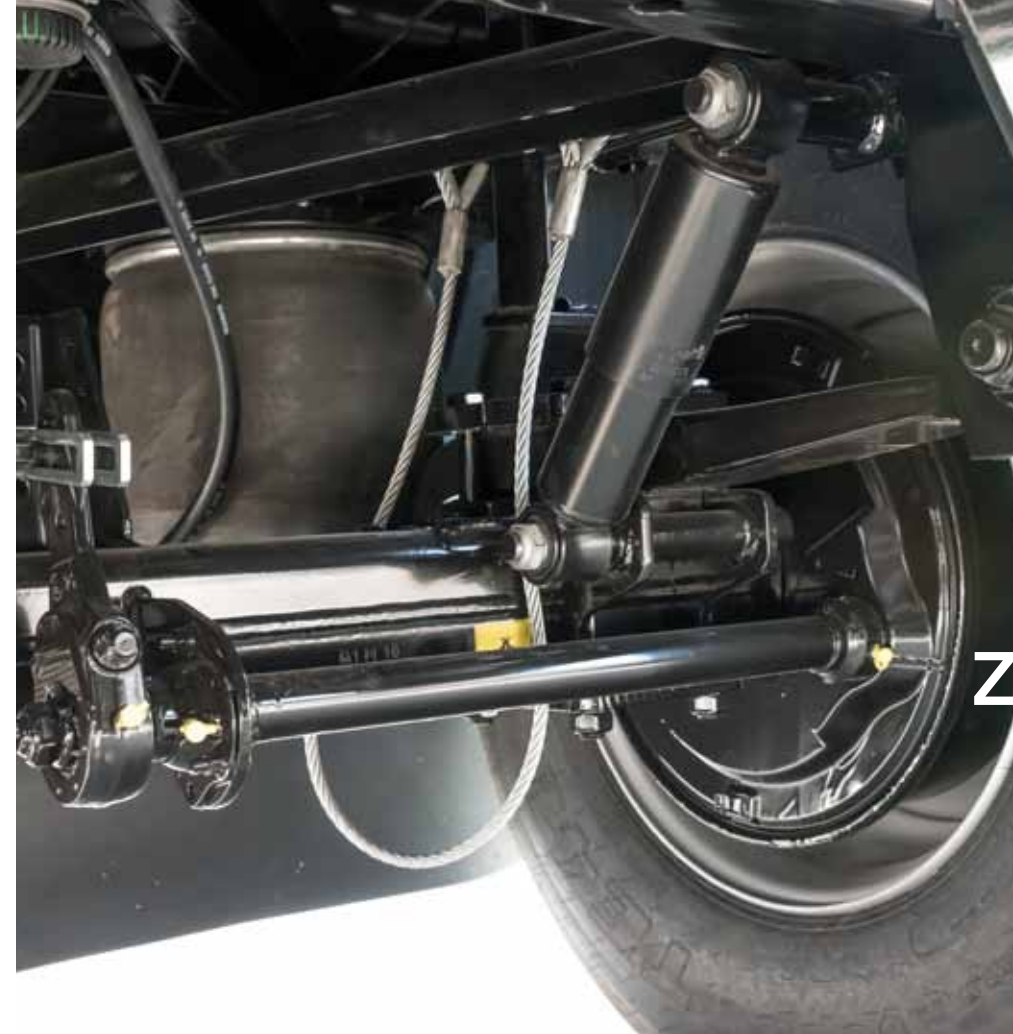
Standardowe zawieszenie pneumatyczne ciężarowe z amortyzatorami
