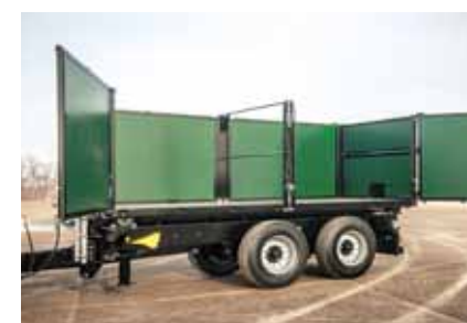
Drzwi portalowe Standardowe drzwi portalowe z lewej strony (opcjonalnie możliwe również z prawej strony), montowane uchylnie
