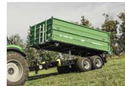
TA 14045 XXL dostępny jako model Aktion lub w wersji z 2 siłownikami wywrotki
